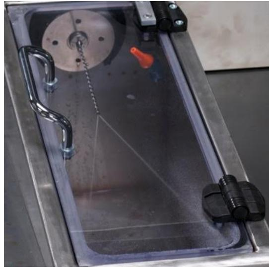
Mit dieser Spülanlage werden die Kühlkanäle von Kleinstwerkzeuge vor der Beschichtung gereingt.
